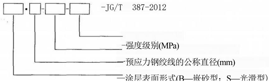
标记示例：公称直径为12.70 mm, 强度级别为1860 MPa 的光滑型环氧涂层钢绞线，其标记为：FECS • S-12.70-1860-JG/T 387—2012。
