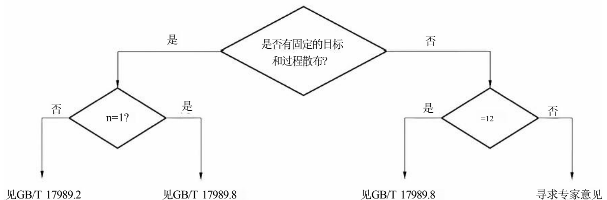
图 1 测量数据选择常规控制图的流程图
