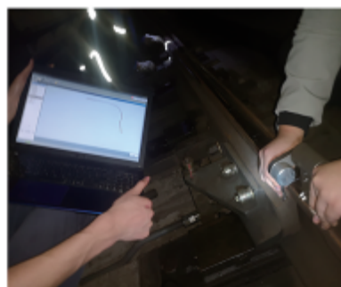
(b) 35 mm 尖轨断面廓形测试
