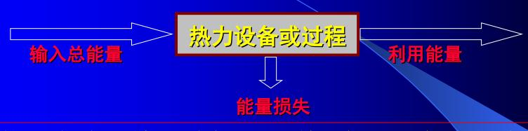
热平衡式 输入总能量 = 利用能量十能量损失
